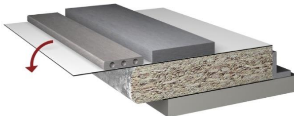
Obrázek 30: Postformování pomocí pohyblivé kovové lišty
