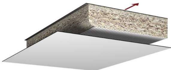
Obrázek 34: Lepení laminátu na nosný materiál
