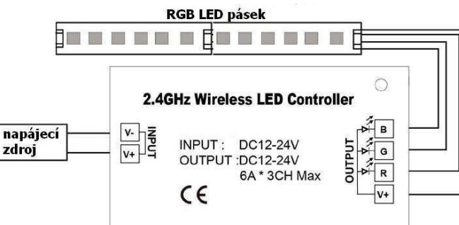
Zapojení by měla provádět odborně způsobilá osoba, použití jiných napájecích zdrojů, trvalého přetížení či přepólování napájecího napětí může poškodit přijímač
