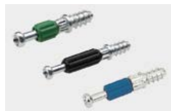
Barevné plastové objímky s rýhovanou neklouzavou strukturou signalizují upínací rozměry. Zelená (upínací rozměr 20 mm) pro Rastex 15, modrá (upínací rozměr 24,5 mm) pro Rastex 25 a černá (upínací rozměr 30 mm) pro Rastex 15.
