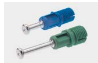
Rychlá, beznářadová montáž, jednoduše rukou zatlačit do boku korpusu. Jasně rozlišení díky barevným rozpěrným pouzdrům: modré pro otvory průměru 8 mm a zelené pro otvory průměru 10 mm.
