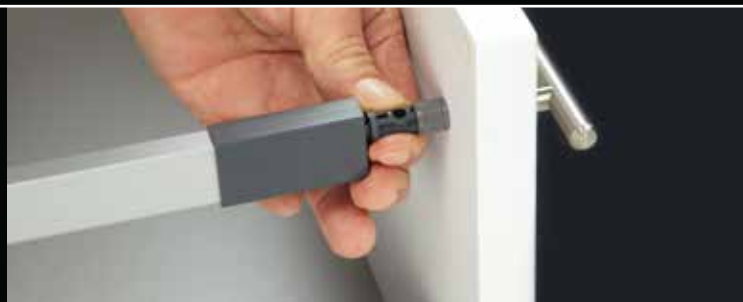
Výškové seřízení čela + / - 2 mm s akustickou zpětnou vazbou
