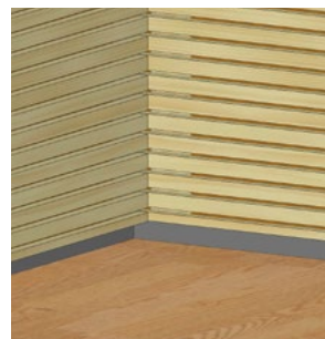
Detail ukončení akustického panelu 50 mm nad podlahou
